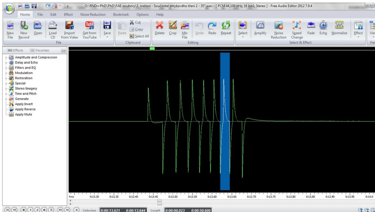
Obr. 1.1.3 Oscillogram experimentu – Měření zrychlení na nakloněné rovině – vyznačení šestého zubu
