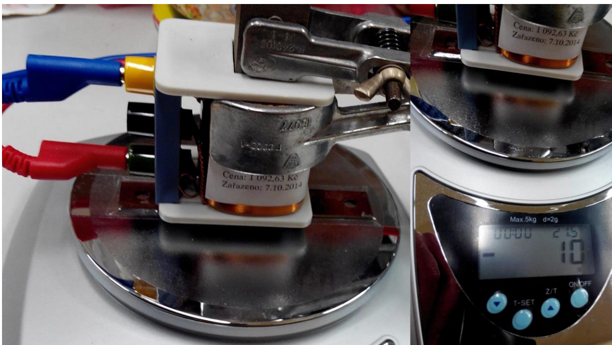
Obrázek 4.1.2 Uspořádání experimentu – Měření rychlosti světla z vakuových konstant – měření permeability
