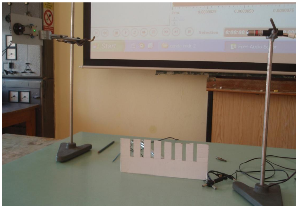
Obr. 24 Uspořádání experimentu s papírovým hřebenem
