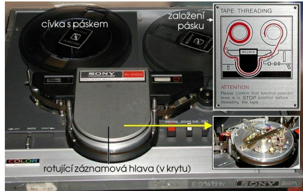
Magnetofony zaznamenávají zvuk nebo obraz na magnetické pásky. Na snímku je stařík videomagnetofon z roku 1975 s rotující záznamovou hlavou – miniaturním elektromagnetem
