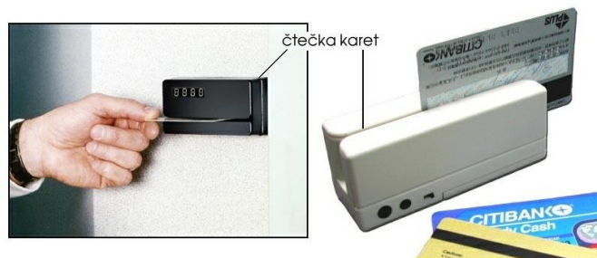
Karty s magnetickou páskou mají magneticky zaznamenané údaje o uživateli. Tyto karty se používají k finančním operacím (např. kreditní), jako elektronický klíč (vstup do objektů) apod.
