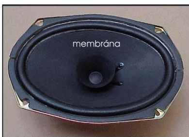
Reproduktor: kmitací cívkou prochází proměnný proud ze zesilovače, v magnetickém poli začne cívka kmitat. Spolu s ní se rozkmitá i membrána a vzniká zvuk
