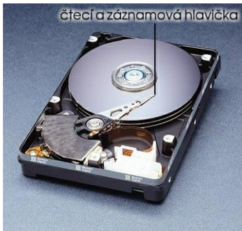
Pevný disk počítače má magnetickou vrstvu se zaznamenanými informacemi. Čtecí a záznamová hlavička je v podstatě miniaturní elektromagnet.
