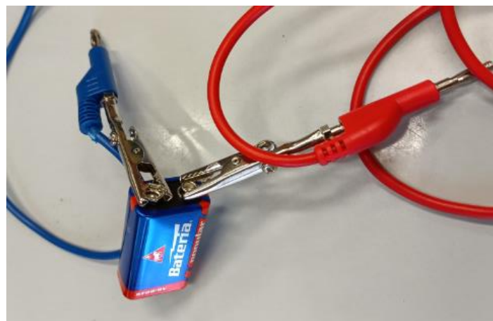
Obr. 2 Detail připojení 9 V baterie.
